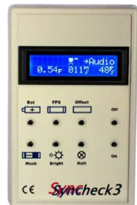
Figur 7-28: Syncheck3 apparat for å måle tidsforskjell mellom lyd og bilde (Pharoah Editorial, Inc)
