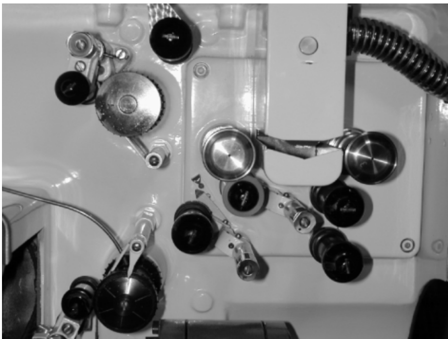
Figur 10-16: Magnetisk lydhode for 70mm film. 70mm hadde magnetiske lydbånd sveiset på filmen. Filmen passerer det magnetiske lydhodet og leses av før filmporten.
