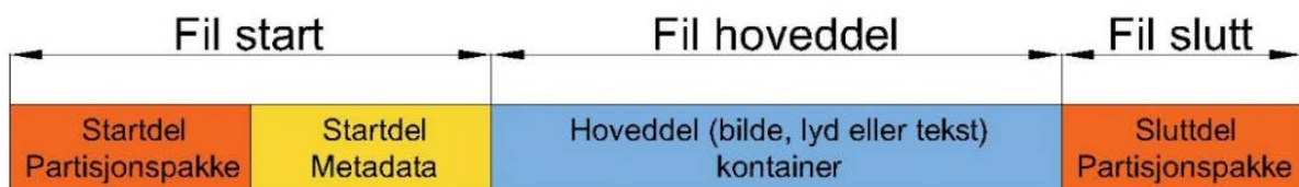
Figur 2-1: TrackFile struktur (DCI)
