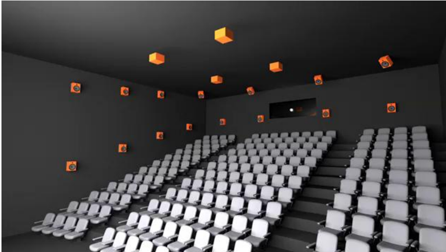
Figur 7-27: Plassering av surroundhøytalere i 2 nivåer og i taket i Barco Auro3D system (Barco)
