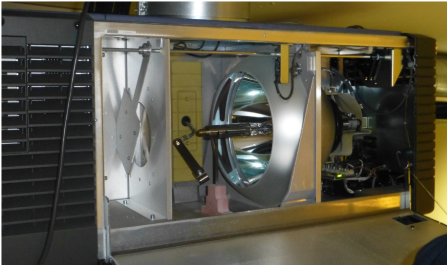
Figur 3-23: Lampehus med xenonkolbe og speil (Christie)
