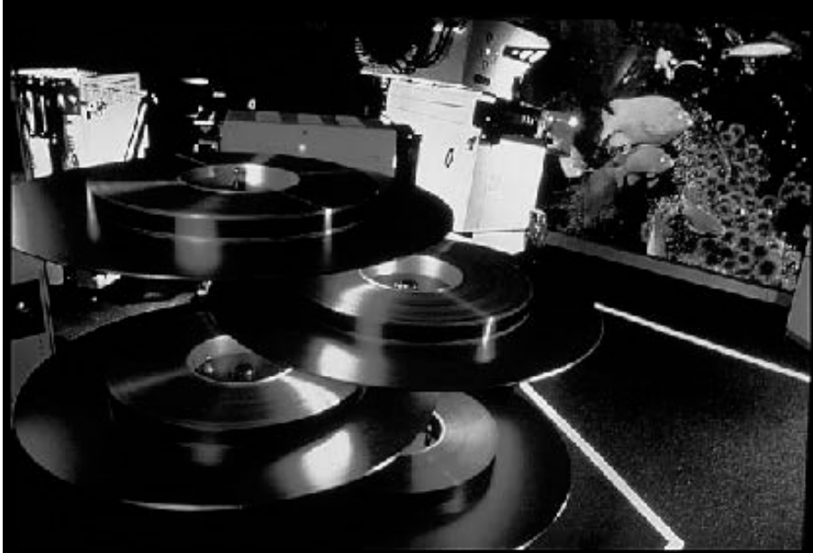
Figur 10-19: IMAX projektor. Bildet viser en IMAX projektor for 3D film. Det er to filmruller, en for bildet til hvert øye. (IMAX)
